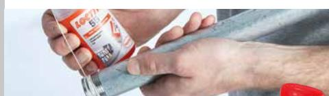
Cordão para fixar e vedar tubos e conexões rosadas metálicas e plásticas, de até 4 polegadas. Ideal para usos imediatos, uma vez que não necessita de tempo para curar. Homologado para água sanitária e gases liquefeitos de petróleo.
