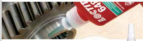
Retentor para montagens de alta resistência. Preenche folgas nas partes a montar, veda e evita o desgaste provocado pelos movimentos. Oferece uma grande resistência em todos os metais e também cola em superfícies oleosas.
