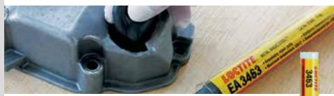
Epoxi bicomponente versátil com carga de aço para reparações de emergência. É aplicado com uma massa para parar fugas em tubos e depósitos, e simultaneamente repara pequenos estragos em alojamentos e orifícios mecanizados.
