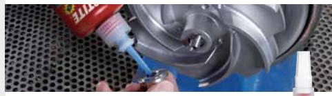
Fixador de rosas adequado para todos os metais, incluindo substratos passivos, que toleram contaminações ligeiras de óleos industriais. Para além disso previne que as peças se soltem devido a vibrações.
