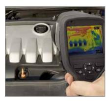
Os instrumentos de termografia industrial são utilizados como ferramentas de validação do processo em aplicações elétricas, eletrónicas, eletromecânicas e de engenharia mecânica. Estes incluem ferramentas, componentes da linha de produção, sistemas de fabrico, entre outros. Para além de aplicações de manutenção preventiva, e de programas de assistência programada, estas câmaras são excelentes instrumentos de
